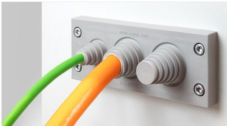
I passacavi a membrana KEL-DPFR permettono il passaggio su cavi con diametri diversi da 3 a 28 mm e di sigillarli secondo IP66. Questo risulta estremamente utile quando non si conosca in anticipo l'esatto diametro del cavo da installare.
