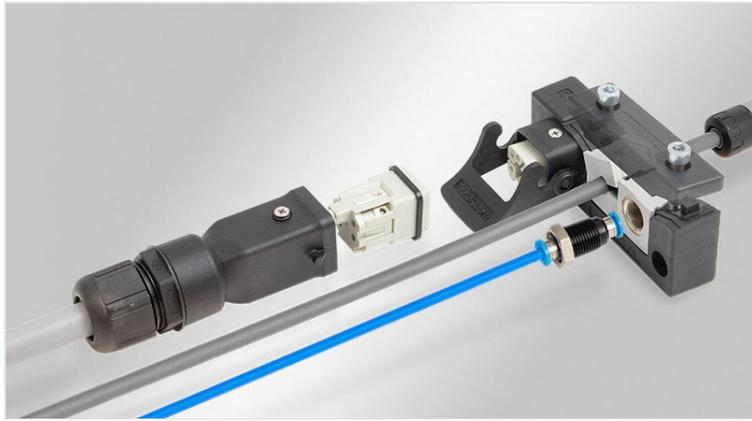
El sistema de interfaz modular (MIS) es una entrada de cables divisible para cables con y sin enchufe en combinación con conectores industriales 3A o 4A. Un conector industrial de tamaño 3A o 4A puede enchufarse directamente en el marco. Los cables con un diámetro de 1 a 15 mm se pueden enrutar, sellar y liberar de tensión de acuerdo con la norma EN 62444.
